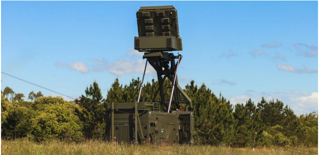
Testes de Aceitação de Fábrica (FAT) do Radar móvel do 4º/1º GCC
